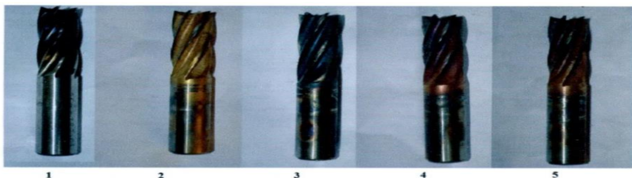
Рисунок 7.19 – Фрезы с различными покрытиями после испытаний на АО «УАПО»
