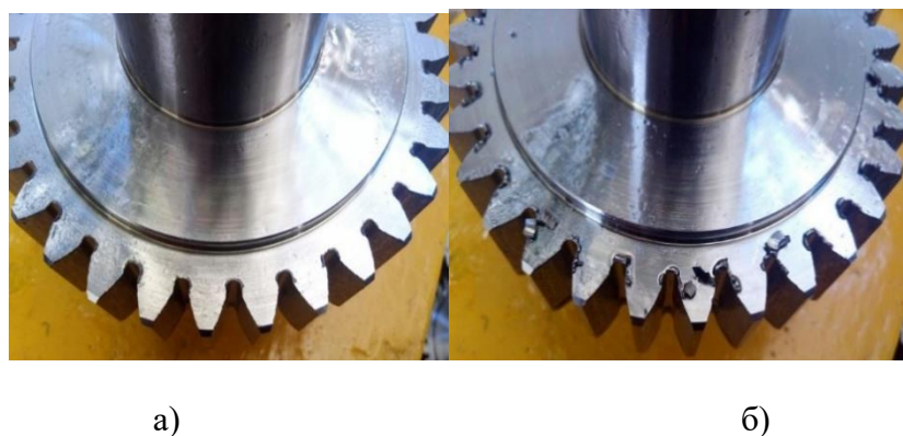
Рисунок 7.20 – деталь «Шестерня» обработанная червячной фрезой (а) с разработанным покрытием и (б) без покрытия
