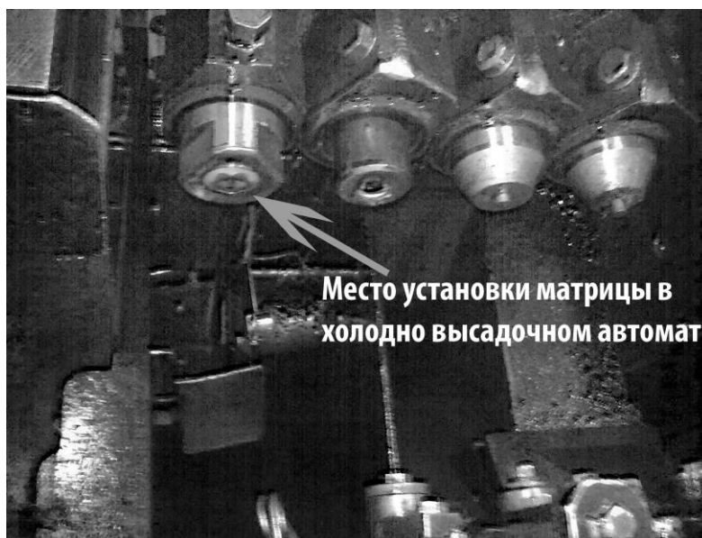
Рис. 7.5 – Расположение матрицы в холодновысадочном автомате.
