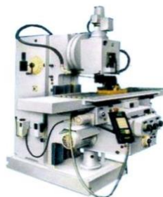
Рисунок 1. Вертикальный консольно-фрезерный станок с крестовым столом 6Т12.
