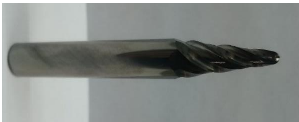
Рисунок 7.11 – Твердосплавная концевая фреза, применяемая при обработке лопатки ГТД без покрытия
