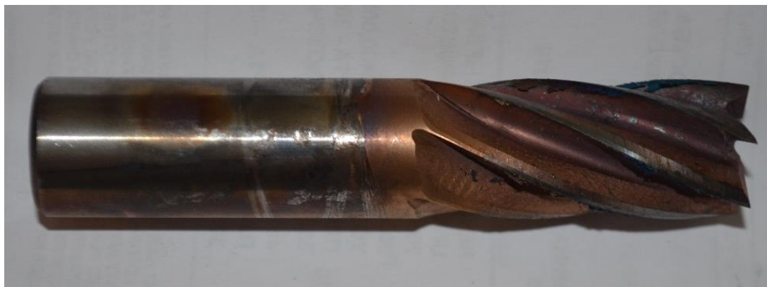
Рисунок 6.24 – Фотография фрезы с покрытием, нанесенного по технологии ML1, после испытания.
