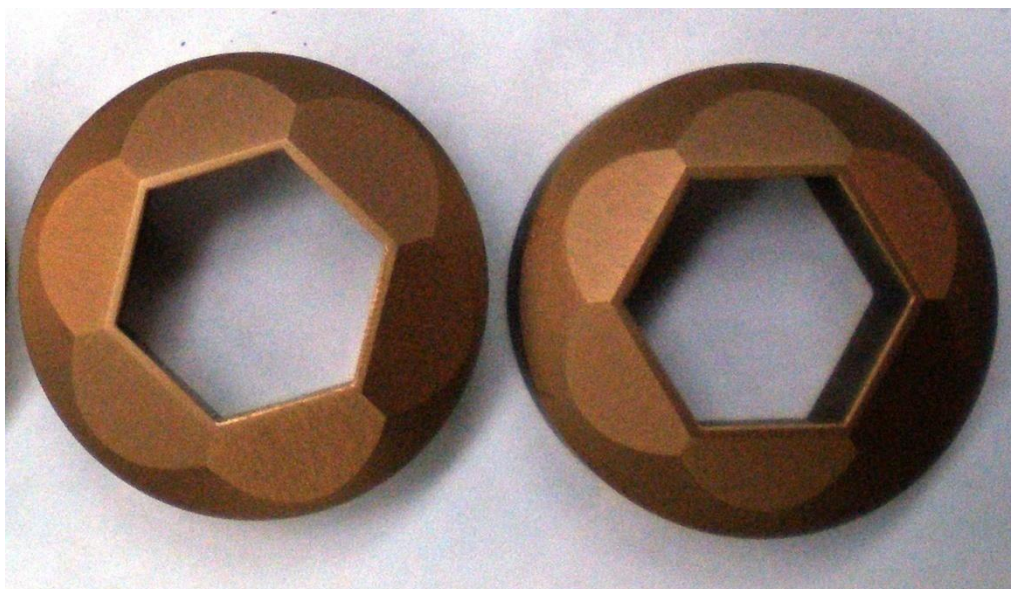
Рисунок 7.2 – Обрезные матрицы износостойким покрытием на основе интерметаллидов и нитридов титана и алюминия
