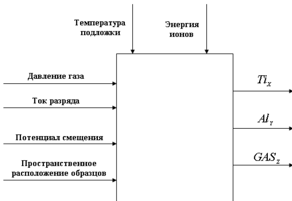
Рисунок 3.18 – Факторы, влияющие на стехиометрический состав покрытий [15].
