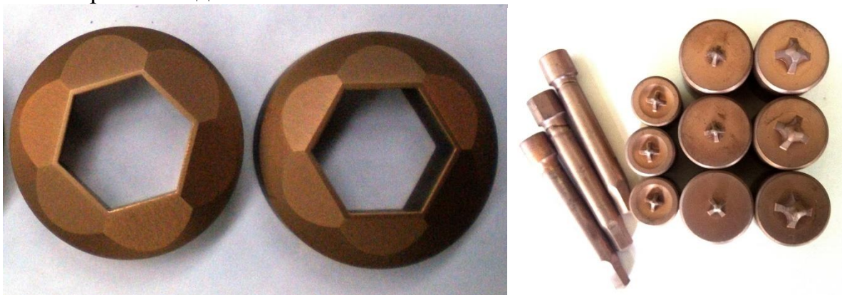
Рисунок 27 – Обрезающие матрицы и пуансоны с многослойным износостойким покрытием на основе «ИнСиТА»
