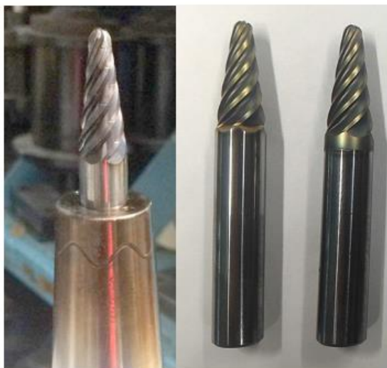
Рисунок 29 – Твердосплавные фрезы с износостойким мультислойным покрытием на основе «ИнСиТА»
