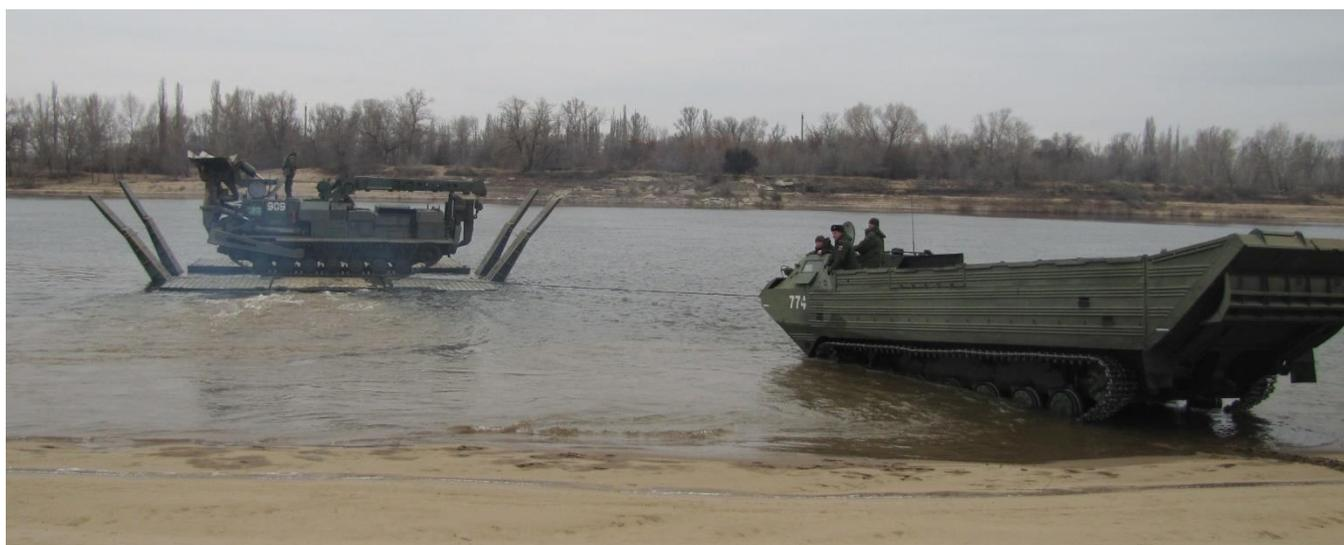
Рисунок 3.7 – Процесс замера силы тяги ВД
