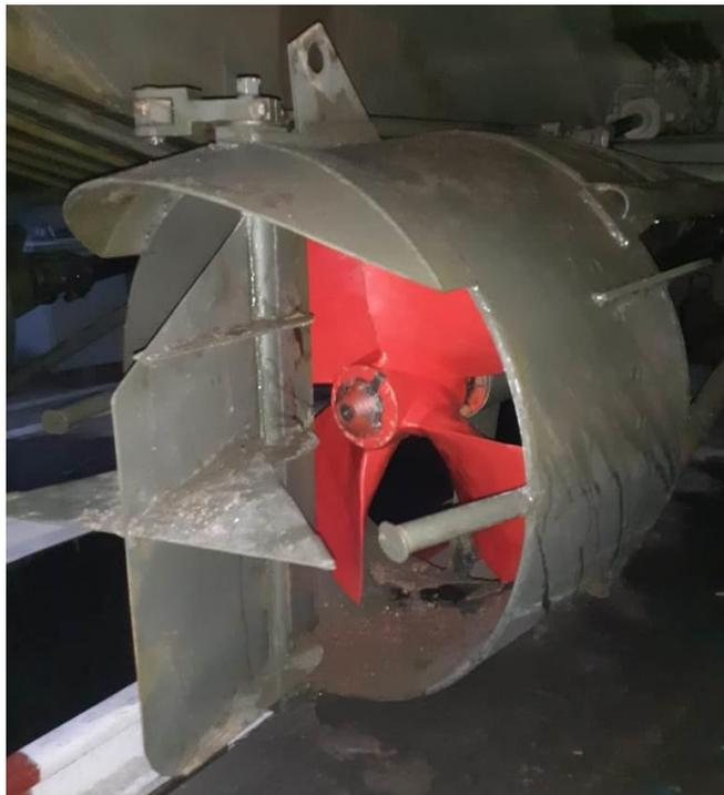
Рисунок 3.4 – ВД ПММ-2М с ГВ улучшенной геометрии
