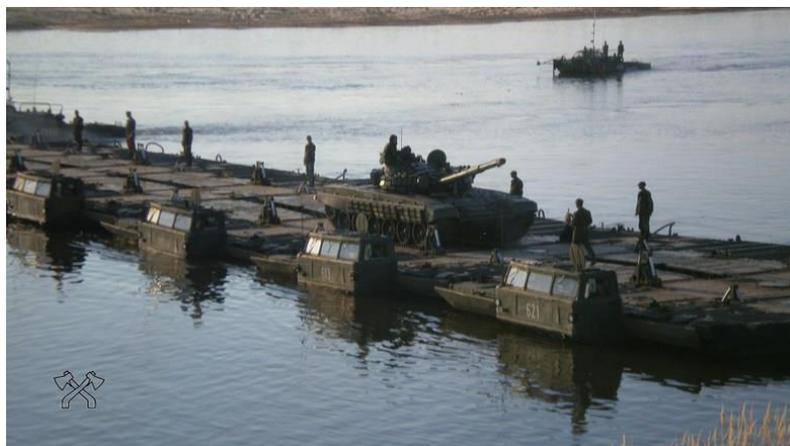
Рисунок 1.5 – Паромный мост, организованный колесной паромно-мостовой машиной ПММ
