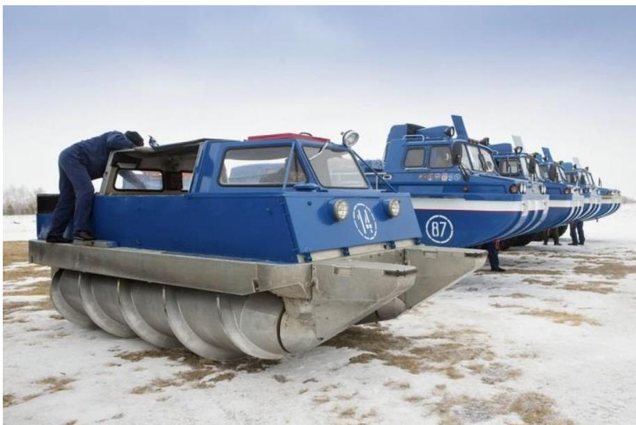
Рисунок 1.23 – Роторно-винтовой снегоболотоход ЗИЛ-29061
