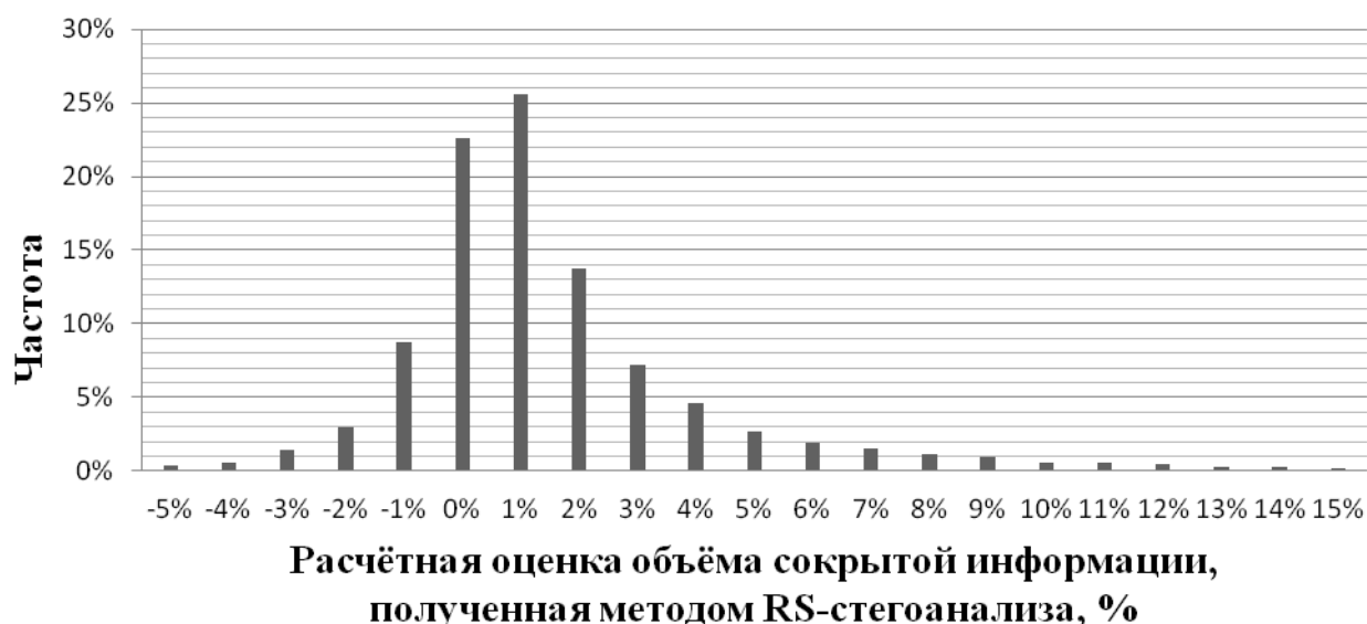
Рисунок 2 - Гистограмма распределения расчётной оценки объёма сокрытой информации, полученной с помощью RS-стегоанализа пустых контейнеров
