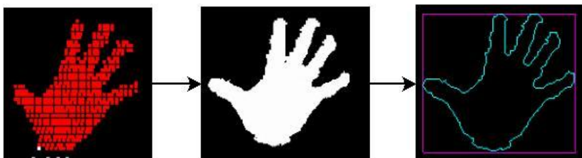
Рисунок 6 – Получение бинаризованного изображения и его контура
