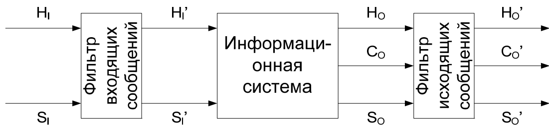
Рисунок 1 – Информационные потоки в системе обработки электронных почтовых сообщений
