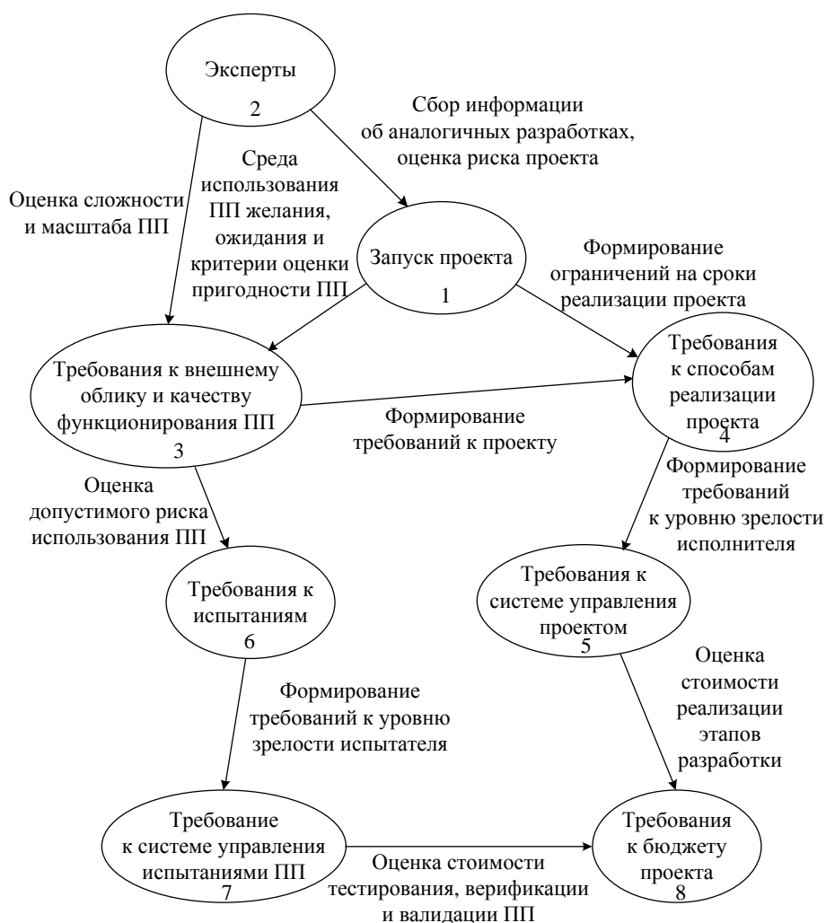
Рисунок 4 – Семантическая модель формирования требований к проекту на ранней стадии его реализации (ПП – программно реализованное приложение)
