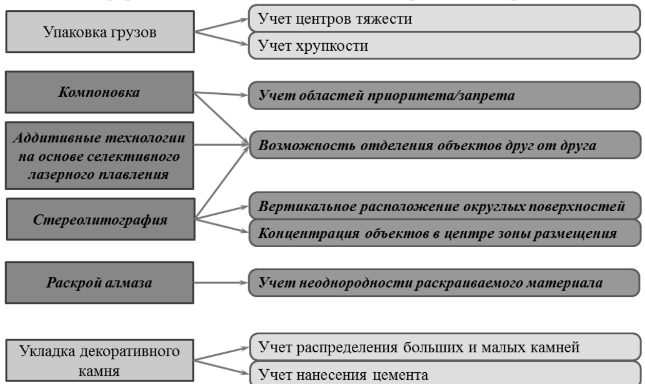
Рисунок 1. Конструктивно-технологические ограничения в задачах размещения трехмерных объектов (курсивом выделены рассматриваемые в данной работе)
