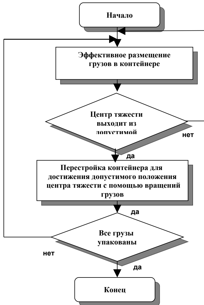
Рисунок 3 – Обобщенное представление алгоритмической структуры решения задачи размещения грузов в контейнерах с учетом их физических характеристик
