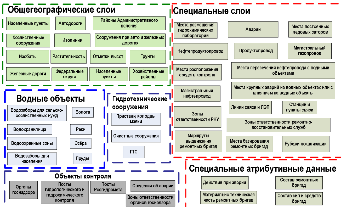
Рисунок 3. Фрагмент структуры базы геоданных разрабатываемой системы поддержки принятия решений при аварийных разливах нефти по водным объектам
