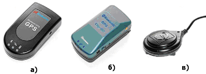
Рисунок 1.2 – Переносные GPS приемники без дисплея: а, б - беспроводное соединение с компьютером (через Bluetooth), в - соединение через провод
