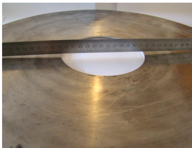
Рисунок 1 – Диафрагма с неплоским входным торцом, вызванным гидроударом
