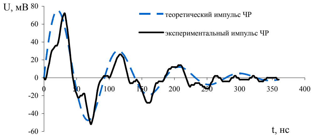
Рисунок 7. Осциллограмма единичного импульса ЧР
