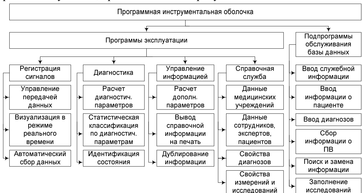
Рисунок 7 – Структура программной инструментальной оболочки ИИС
