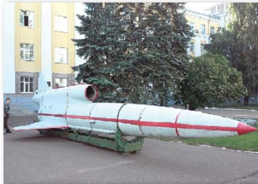
Ту-141 «Стриж» — многоцелевой советский оперативно-тактический разведывательный беспилотный летательный аппарат. Его двигатель ТРД КР-17А разработан при непосредственном участии А.А.Саркисова.
