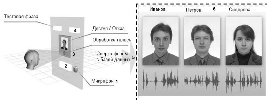
Рисунок 4 - Интерфейс модуля идентификации с защитой от атак.
